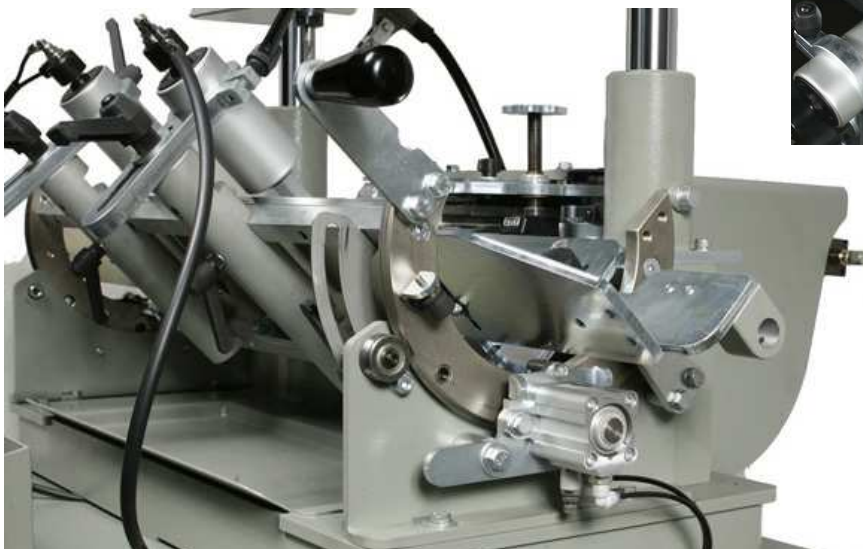
Détails de la console permettant le pivotement de 90° du profilé suivant son axe. Le blocage en position est pneumatique.
